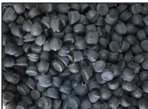
Figura 6.17 - Amostra de grão de PVC com rebarba devido ao desgaste das lâminas de corte.
