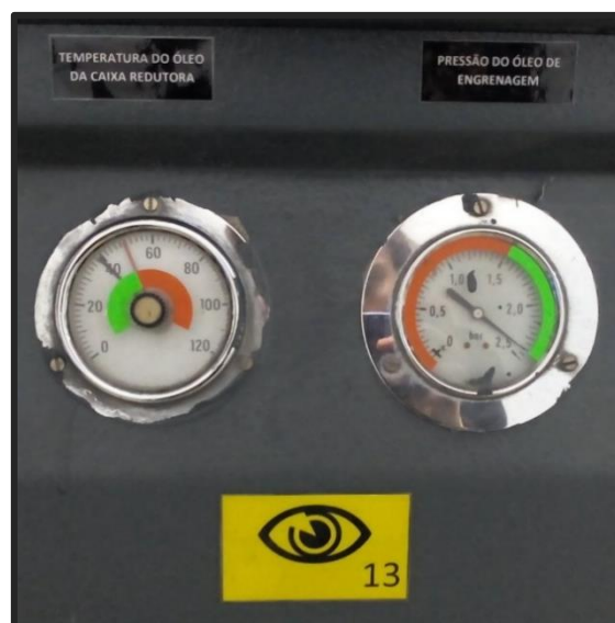
Figura 6.12 - Aplicação de gestão visual a indicadores de uma extrusora com indicação do número do ponto de inspeção correspondente.
