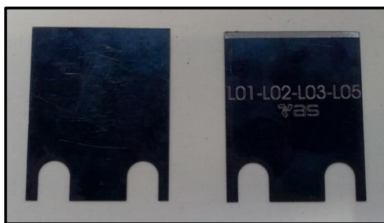
Figura 6.19 – Face plana (a da esquerda) e face afiada (a da direita) de uma lâmina de corte.
